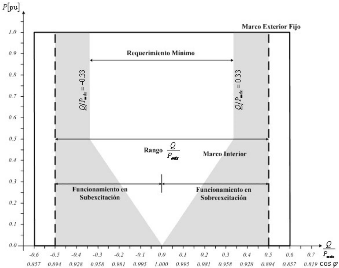
Figura 8: Diagrama P-Q/ $P_{m\acute{a}x}$  de una Central Eléctrica.
