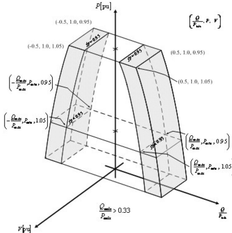
Figura 7: Diagrama V-P-Q/P<sub>máx</sub> de una Central Eléctrica Síncrona.
