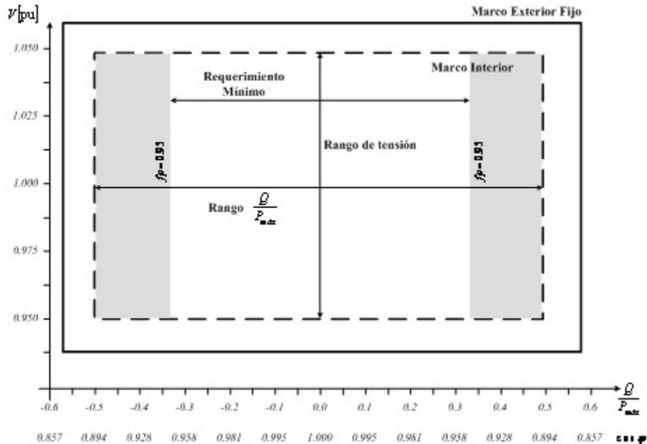
Figura 6: Diagrama V-Q/ $P_{\text{m}\acute{a}\text{x}}$  de una Central Eléctrica.
